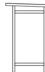
Modèle d'abri-bus préfabriqué POLYMOBYL "Ligne 25°&CIE" : réutilisation de la dalle existante, structure et toiture en aluminium thermolaqué (RAL 8017 ou 8019), panneaux et dessous de toit en mélèze, Dimensions Lg 3m x 1.80m
